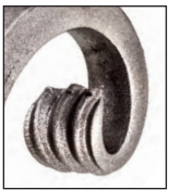
Hot forged ends Terminali fucinati a caldo
