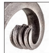
Hot forged scroll Riccio battuti a caldo
